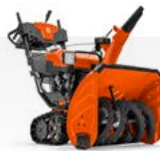
HUSQVARNA ST 424 / ST 424T Husqvarna Egov/EFI motor, volledig stalen console/ geheel stalen constructie en rupsbanden voor een betere tractie, hydrostatische transmissie, LED verlichting, elektrische start-sleutel en verwarmde handgrepen. ST 424: gietijzeren 12" rotor. ST 424, 961 93 01-02 ST 424T, 961 93 01-32
